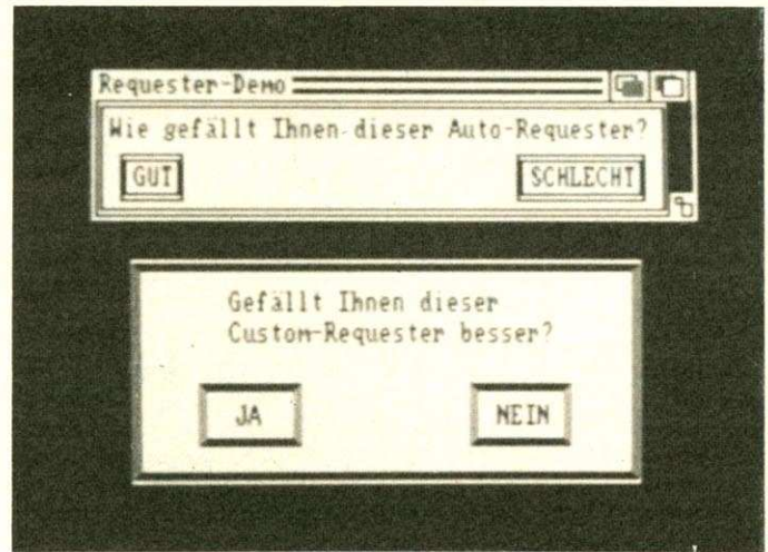
Bild. Oben ein AutoRequester und unten ein CustomRequester, die von »RequesterDemo« gezeigt werden
