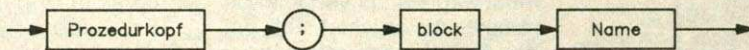
Bild 2a. Die Deklaration einer Prozedur besteht aus Kopf, Block und einem Namen
