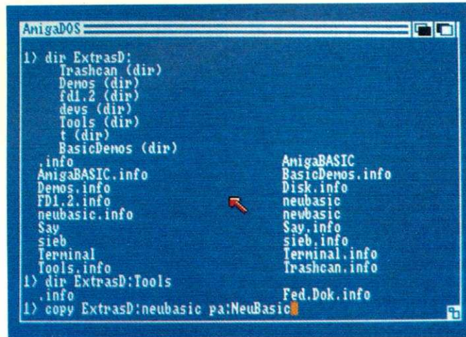
Im Gegensatz zur Workbench muß im CLI der Name des Programms über die Tastatur eingegeben werden
